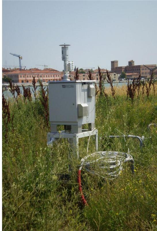
**Fig. 2. 3** Campionatore gravimetrico (Tecora Skypost PM).
